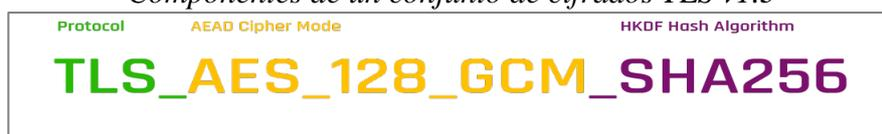
Los esquemas de cifrados con autenticación AE (Authenticated Encryption) utilizan un cifrador simétrico (de bloque o de flujo) y un mecanismo MAC. AEAD (Authentication Encryption with Associated Data) que ofrece la capacidad de aplicar el cifrado solo a la autenticación (Centro Criptológico Nacional, 2017).
