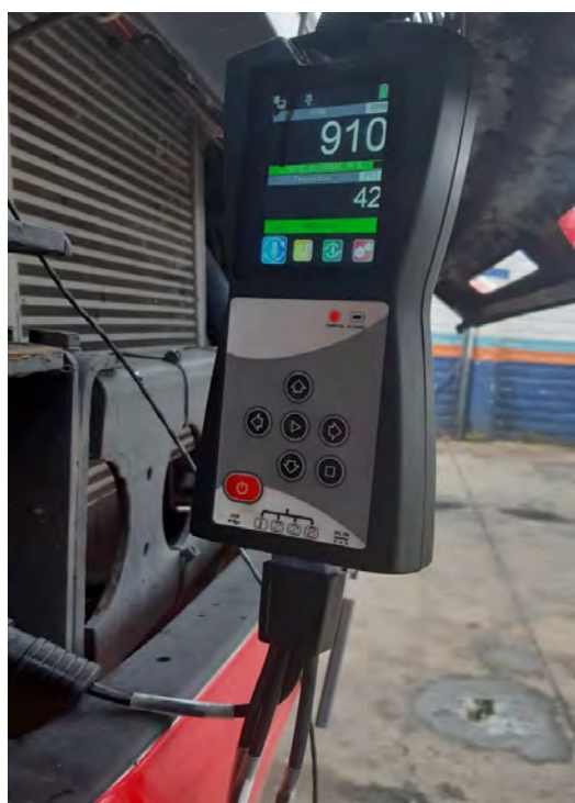
Fig. 1 Equipo Brain Bee® MGT 300 EVO captando datos de velocidad de giro y temperatura del motor
