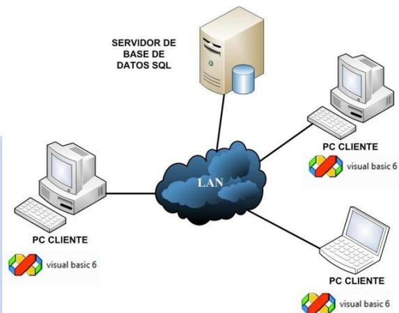
Figura 1. Diagrama de conexión del software
