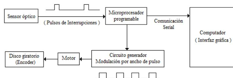
El motor de corriente continua es un dispositivo que transforma la energía eléctrica en mecánica; esta característica permite producir un movimiento giratorio en el eje, en consecuencia, se produce una rapidez de rotación en el disco proporcional al voltaje de alimentación. El voltaje de alimentación del motor es regulado por la modulación por ancho de pulso (PWM).
