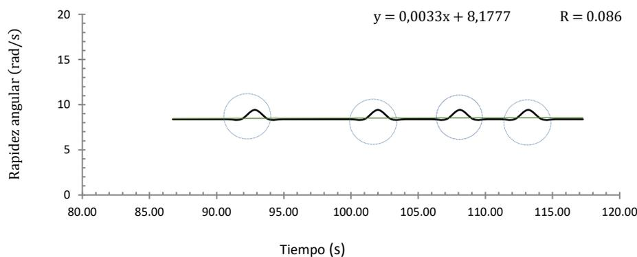
El coeficiente de correlación  $R$  para la Figura 8, es 0.086. Este valor indica que no existe una relación directamente proporcional entre las variables porque el valor de  $R$  es positivo y débil. Se estima que si se incrementa el tiempo, la rapidez mantendrá su valor constante.
