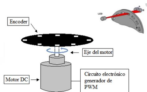
El tren de pulsos generados por el giro del encoder y registrados por el sensor son enviados al microprocesador para ser digitalizados. La recepción de los pulsos se realiza mediante la configuración de un pin de Arduino como entrada. La parte principal de la programación es el registro del número de pulsos que se genera en 1000 milisegundos.
