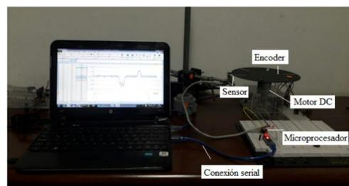
Para utilizar el sistema de adquisición de datos se debe conectar el Arduino al computador mediante el cable USB. Encender el dispositivo mediante el interruptor On/Off. Ejecutar y abrir la carpeta del programa PLX-DAQ. Ejecutar la hoja de cálculo Datos\_Hoja de Cálculo.
