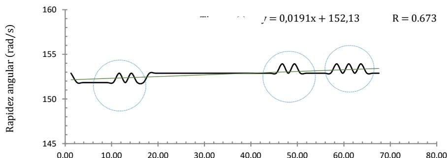
En conclusión, para el tramo 1, la aceleración angular tiende a cero y la rapidez angular tiene una media de 152,13 radianes por segundo. Además el coeficiente de correlación R entre las variables tiene un valor de 0.673, que indica una relación directa y correlación positiva fuerte. Se estima que, si se incrementa el tiempo, la rapidez aumentaría de forma lenta y gradual.
