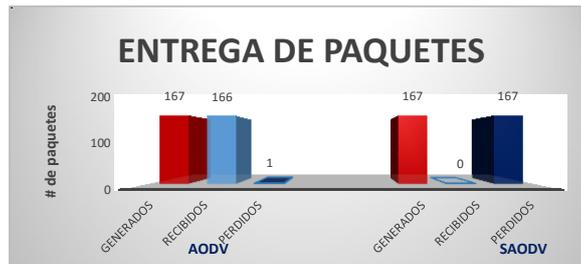
Fig. 21. Comparación de la tasa de entrega de paquetes entre los protocolos, de todos los paquetes generados ninguno llega a su destino en el protocolo SAODV
