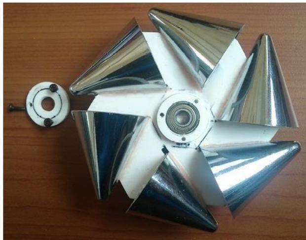
**Fig. 10.** Micromolinete en teflón
