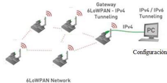
Fig. 4. Prototipo de red 6LoWPAN a implementarse
