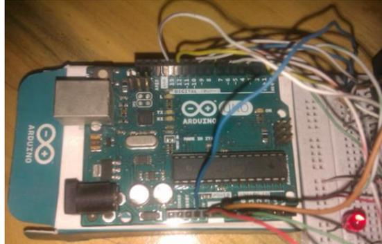
**Figura 17: Placa Arduino UNO**
