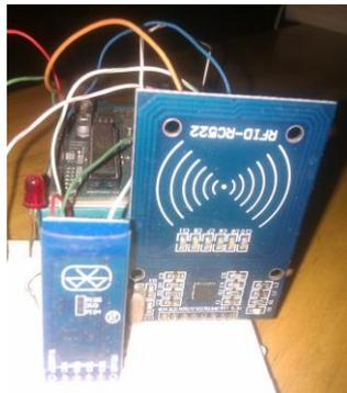
Figura 16: Modulo Bluetooth (HC-05) y Lector RFID (RFID-RC522)
