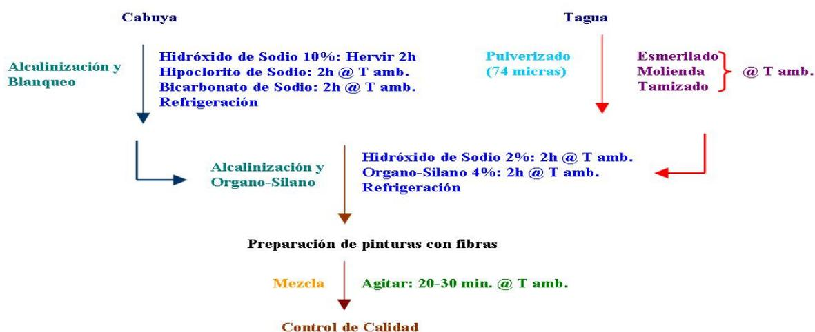
**Figura 4.** Tratamientos aplicados a las Fibras
