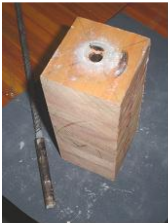
Figura 13. Adhesivo SIKA32 - Modo de ruptura,
