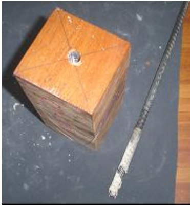
Figura 12. Adhesivo A313 - Modo de ruptura.
