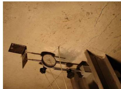
**Figura 8.** Extensómetro mecánico compuesto por relojes comparador (RC) para medición de la deformación del concreto.
