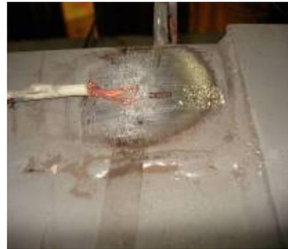
**Figura 7.** Extensómetros eléctricos de resistencia (EER) pegados en la mesa y la alma de la viga.
