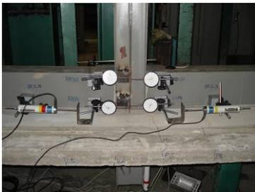
**Figura 5.** Relojes comparadores (RC) para medir la rotación relativa de la conexión.
