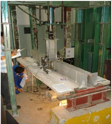
**Figura 1.** Configuración básica de los ensayos e condición de extremidad adoptada en los modelos.
