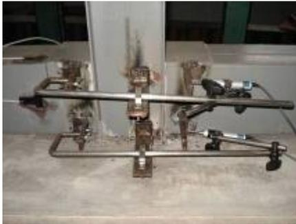
**Figura 4.** Transductores de desplazamiento (DT) de la conexión.
