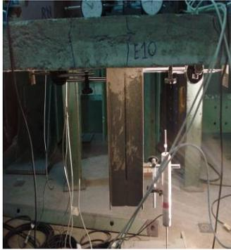
**Figura 3.** Transductor de desplazamiento (DT) vertical en la sección central del modelo.
