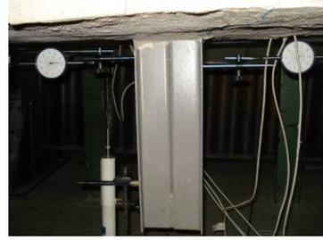
**Figura 6.** Relojes comparadores (RC) usados como extensómetros mecánicos.
