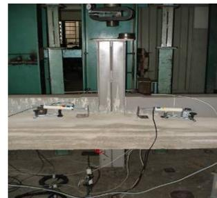
**Figura 2.** Transductores de desplazamiento (DT) para medición del deslizamiento relativo entre el acero y el concreto.
