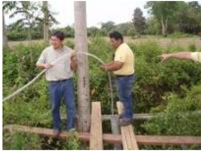
Figura 6. Inyección de la solución de trazador NaCl
