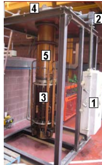
Fig. 1: Estructura básica de un CTC
