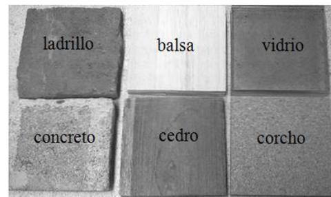
**Figura 3.** Placas de muestra de materiales
