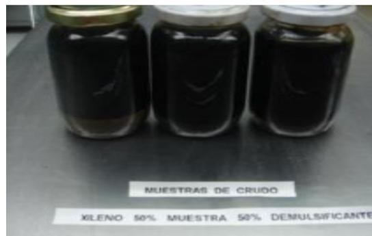
**Fig. 7.** Muestras en laboratorio de los fluidos de retorno en laboratorio previo a la separación de los productos no miscibles. (agua-petróleo)<sup>[14]</sup>
